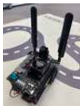
カメラでルートを認識して自動走行させる
